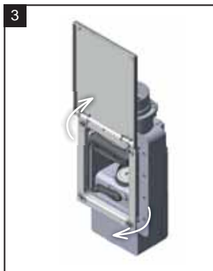
3 Prima di procedere al serraggio delle viti, regolare il posizionamento dello sportello
