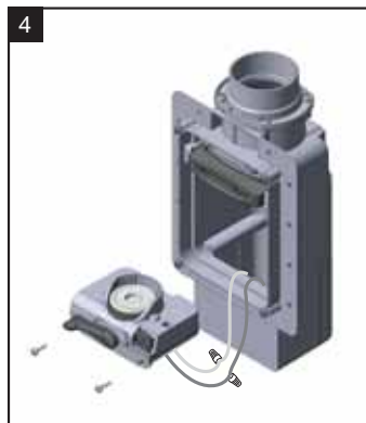
4 Collegare i due fili dell'interruttore del blocco inferiore ai fili del cavo della linea micro dell'impianto di aspirazione e riposizionare il blocco inferiore della presa.
