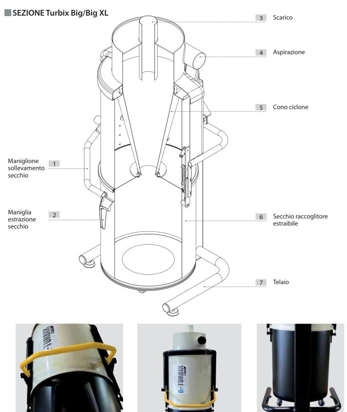
Il separatore Turbix Big ha una grande capacità di raccolta delle polveri
