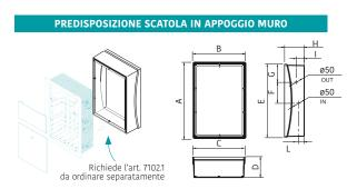
Per la predisposizione in appoggio muro, inserire la scatola a incasso art 71021 all'interno della cornice.
