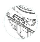
La **valvola rompivuoto** si apre automaticamente facendo arrivare aria al motore quando il flusso, in ingresso dal tubo di aspirazione, è ridotto o assente, anticipando l'intervento della protezione termica.
