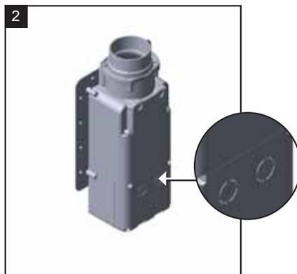
Faire passer le câble de ligne micro de l'aspirateur par les trous pré-percés dans le couvercle.
