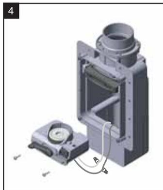
Connecter les deux fils de l'interrupteur du bloc inférieur aux fils de la ligne micro du système d'aspiration et repositionner le bloc inférieur de la prise.
