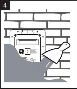
Insérer l'arrière de la contre-prise dans le mur (figure 4).
