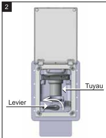
Tourner le levier de 180° dans le sens inverse des aiguilles d'une montre et extraire le tuyau
