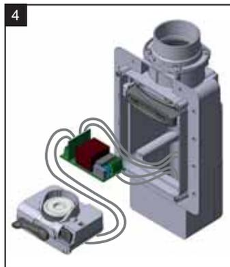
Placer la carte du récepteur dans le compartiment situé sous la prise et remettre le bloc inférieur en place.
