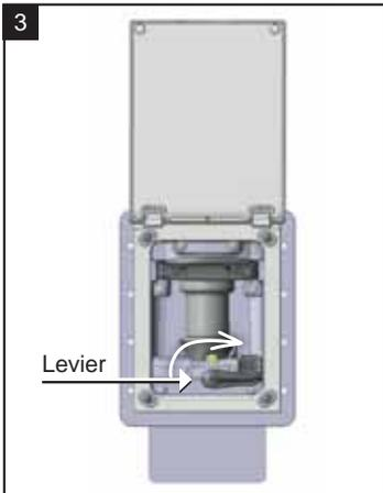
Une fois le tuyau rétracté entièrement à l'intérieur de la prise, tourner le levier inférieur de 180° dans le sens des aiguilles d'une montre pour arrêter l'aspiration
