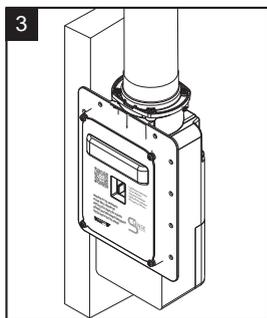
Installer le tuyau en PVC (figure 3). Coller le tuyau au raccord de la contre prise en veillant à ce qu'il soit bien ajusté à l'intérieur du raccord.
