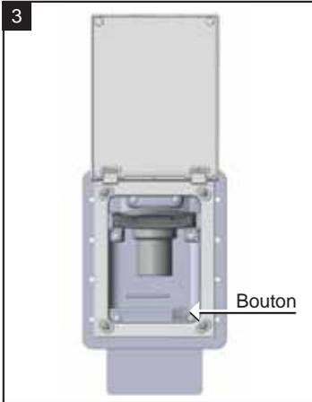
Une fois le tuyau rétracté entièrement à l'intérieur de la prise, appuyer sur le bouton en bas à droite pour arrêter l'aspiration
