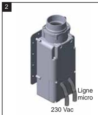
Faire passer le câble de la ligne micro du système d'aspiration et une alimentation électrique de 230Vac à travers les trous pré-perçés dans le couvercle
