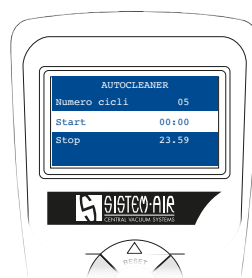
Settaggio Autocleaner tramite display della centrale aspirante Tecno Star Dual Power
